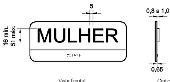
Figura 54 — Sinalização táctil - Exemplo (Dimensões em milímetros)
